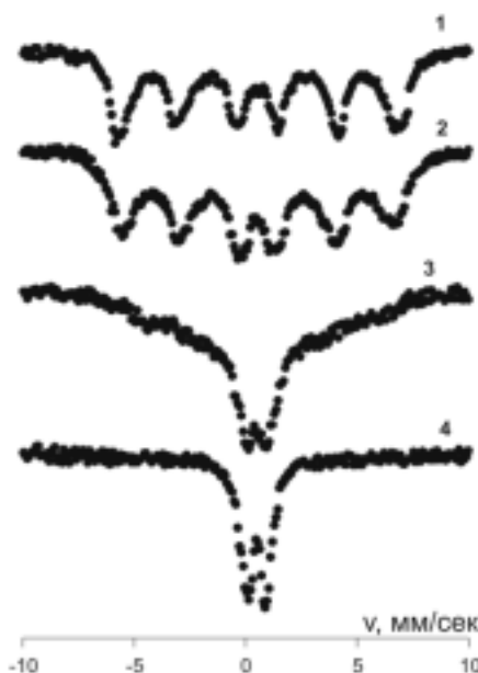
Рис.2. Спектры эффекта Мессбауэра образцов: 1-№10, 2-№24, 3-№15б 4-№2
