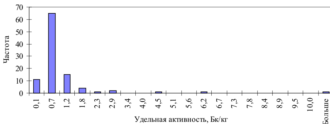
Рис. 3. Распределение результатов определения плутония в пробах почв, отобранных в 30-километровой зоне ГХК
